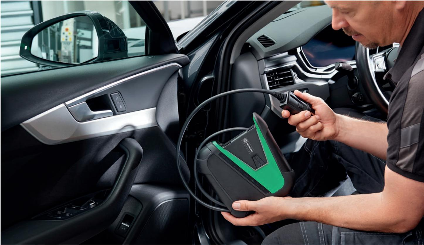
Im robusten Gehäuse des mega macs X konzentriert sich die gesamte Logik, also der Prozessor, die Diagnosesoftware und die integrierten Diagnoseprotokolle – darunter CAN FD und DoIP für jüngste Fahrzeuggenerationen. Ein großer Vorteil, denn mit diesen können viele ältere Diagnosegeräte nicht mehr kommunizieren.
